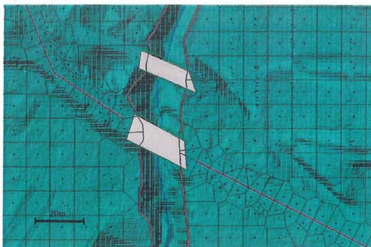
Extrait de la structure d'un modèle hydraulique
